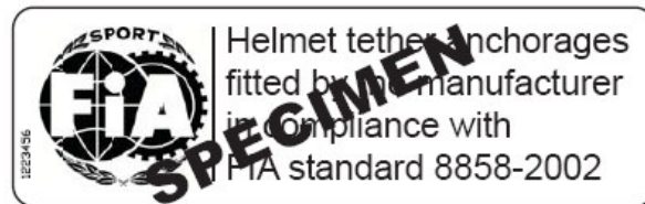
Figura 9. Etichetta di identificazione per caschi equipaggiati in origine con gli inserti HANS®.
